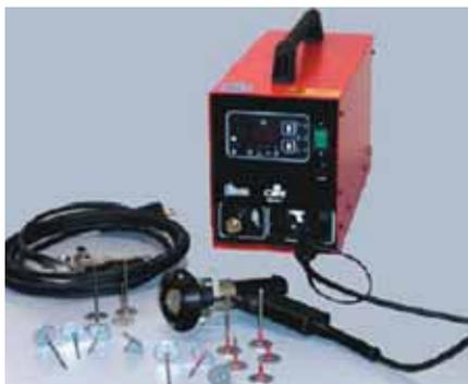
Приварной элемент, закрепленный в магнитном держателе пистолета протыкает изоляцию. После нажатия пусковой кнопки на рукояти пистолета мгновенный электрический разряд приварит штифт к стали. Шайба приварного элемента сама фиксирует изоляцию после приваривания.
