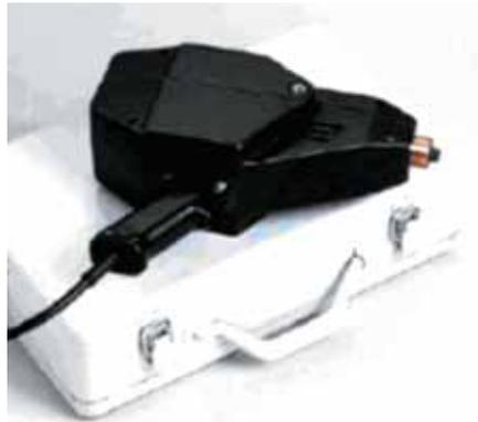
Приварной штифт вставляется в магнитный держатель. После нажатия пусковой кнопки на рукояти пистолета мгновенный электрический разряд приварит штифт к стали. Изоляция фиксируется на игле при помощи блокирующих шайб.
